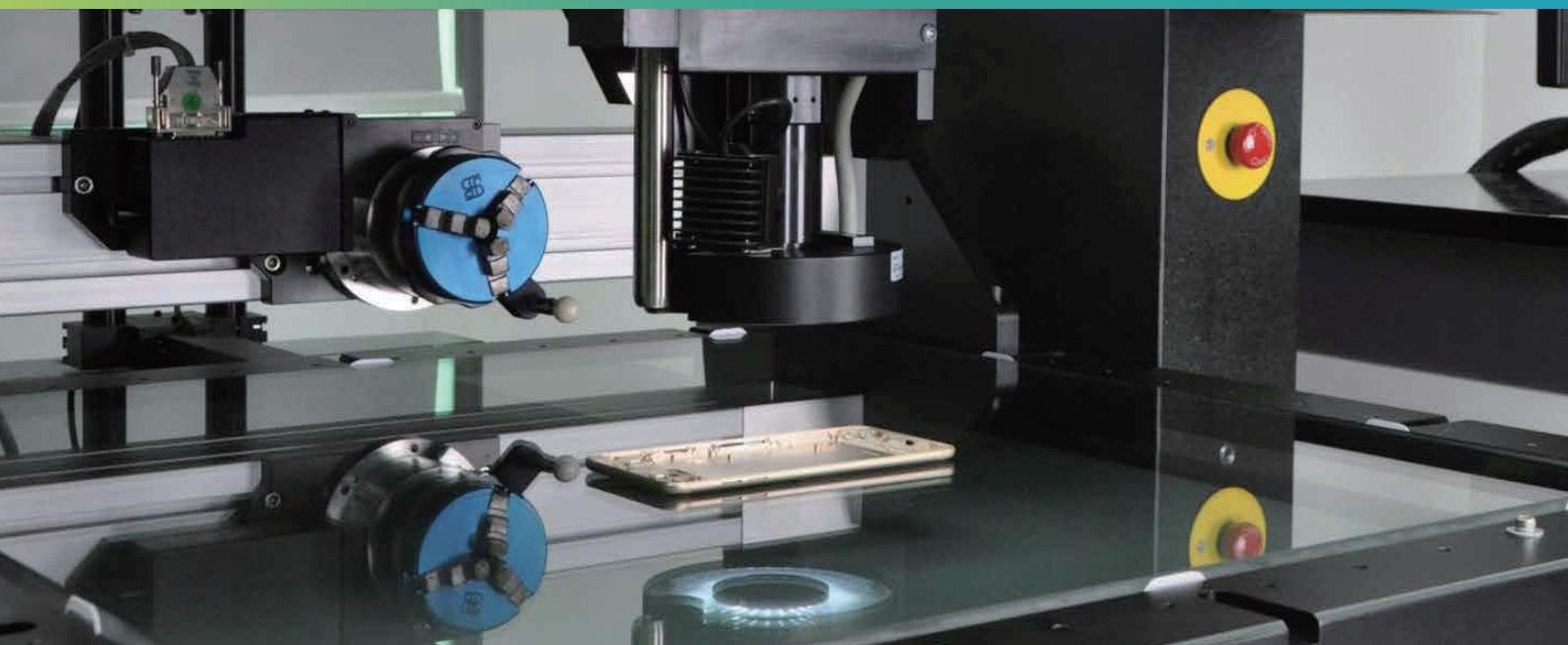
此方案为实验室离线自动化方案，集成多台三坐标测量机、工业机器人、第七轴导轨、自动化夹具、自动上下料系统、扫码系统、工件翻转等，同时配置 Smart Quality 质量管理平台，包含多项创新技术，可以完成自动上下料、自动识别工件、自动检测、自动采集数据、自动分析、设备状态管理、监控等诸多功能。
